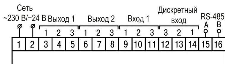
Рисунок 5.6 – Общая схема подключения для корпуса Н
