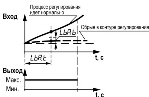
Рисунок 7.4 – Диагностика неисправности контура регулирования
